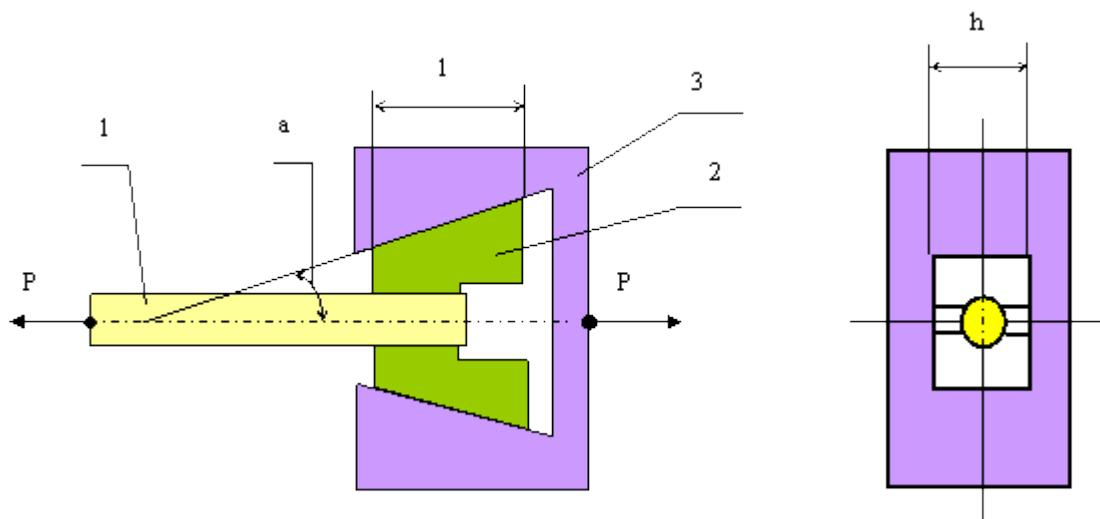
При исследовании механических характеристик материала, испытываемый образец 1 зажимается в клиновых плашках 2 клиновой головки 3 разрывной машины и подвергается растяжению силой Р.
