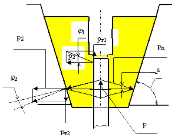
Сила растяжения  $P$  передаётся на испытываемый пруток по контакту с плашками и на зажимную головку по контакту с плашками. Из рисунка
