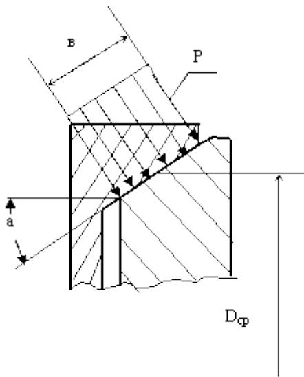
От действия силы  $F_a$  на конической поверхности соприкосновения полумуфты возникает удельное давление  $P$  и удельные силы трения  $P_f$ . Силы трения, направленные по касательной к окружности конуса, используются для передачи крутящего момента. Рассматривая равновесие
