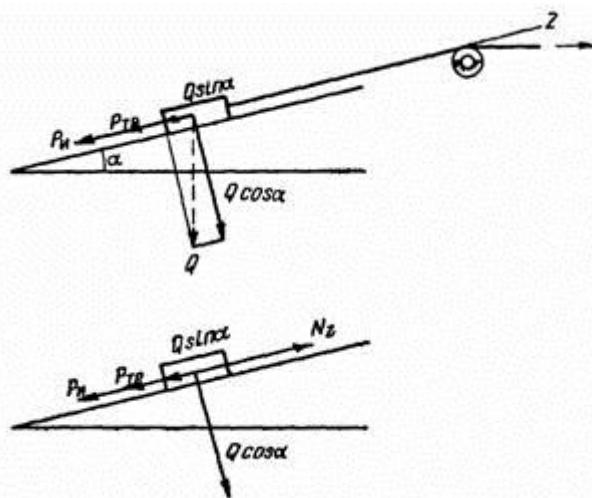
Сила инерции направлена в противоположную сторону силе натяжения троса и равна  $F_u = ma$ ,
