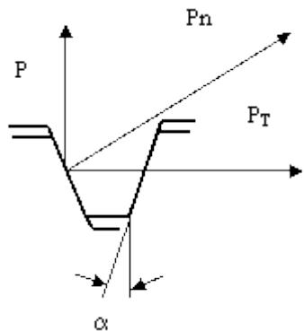
Осьевая сила " $P$ " пружины на полумуфту создаёт окружную
