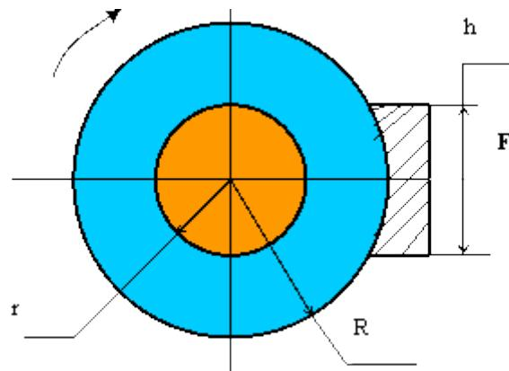
Маховое колесо кривошипных ножниц 1 вращается на оси 2 с угловой скоростью  $\bar{\omega}$ . Радиус маховика  $R=0,4$  м. Радиус оси  $r=0,075$  м. Определить сколько оборотов  $n$  сделает колесо до полной остановки после прекращения
