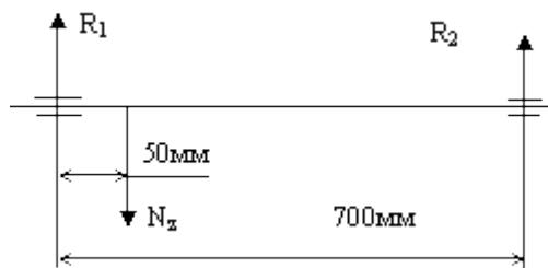
Для выбора подшипников определим максимальные нагрузки. На рисунке приведена расчётная схема вала барабана, когда трос находится на
