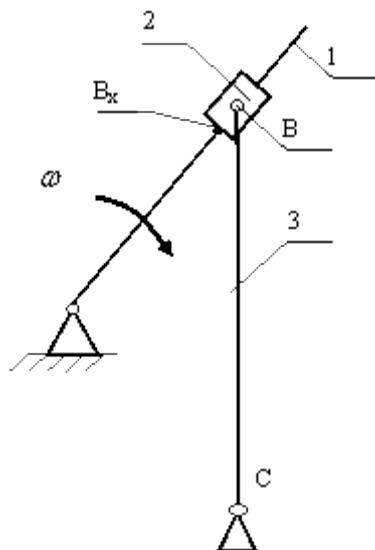
Составим уравнения движения звеньев в векторной форме:  $\ddot{V}_B = \ddot{V}_C + \ddot{V}_{BC}$
