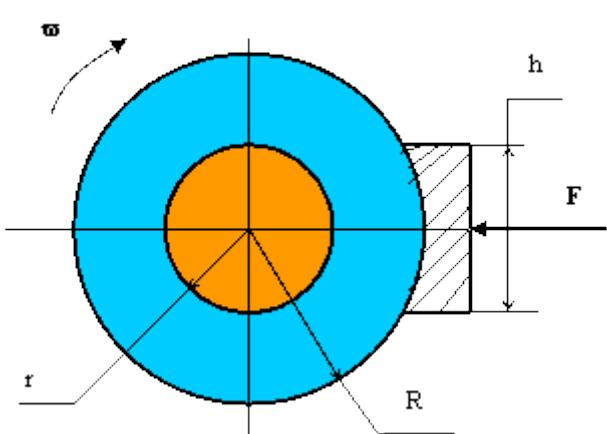
Маховое колесо кривошипных ножниц 1 вращается на оси 2 с угловой скоростью  $\varphi$ . Радиус маховика  $R=0,4$  м. Радиус оси  $r=0,075$  м. Определить какую силу  $F$  необходимо приложить к тормозной колодке, чтобы колесо совершило до полной остановки 0,2 оборота, а также определить контактное напряжение между колодкой и колесом в момент приложения данной силы.
